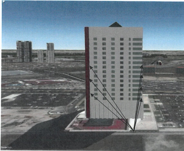
Ubicación de estación total para mediciones lado poniente
